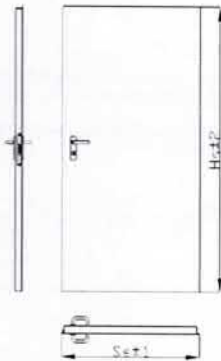
Rys. 2 Wymiary skrzydeł drzwiowych PortaSteel® Steel E130
